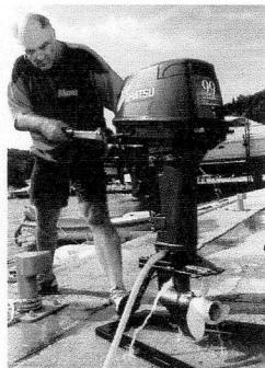
Ispiranje motora slatkom vodom vrši se uz pomoć posebnog adaptera. Tisk priključene vode ne smije biti prevelik. Motor mora biti upaljen i zagrijan na radnu temperaturu kako bi termostat otvorio kanale i propustio vodu kroz sustav
